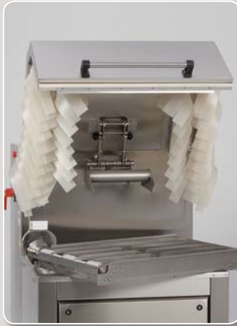
Minimaler Aufwand: Sekundenschnell ist der Tankinnenraum zur gründlichen Reinigung frei zugänglich.
