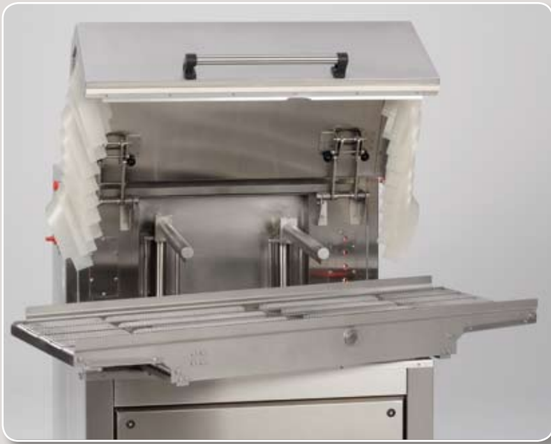
WEBOMATIC CleanDesign auch im Inneren: Problemlos lässt sich das Transportband entnehmen, während die Gerätehaube oberhalb in sicherer Parkposition eingerastet ist.
