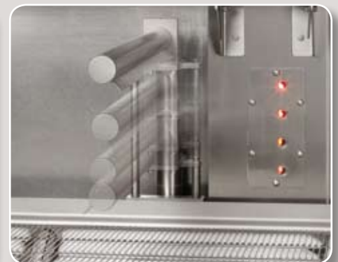
Idealposition: Die beweglichen Gebläsedüsen passen sich dem Konturverlauf des Produkts perfekt an.
