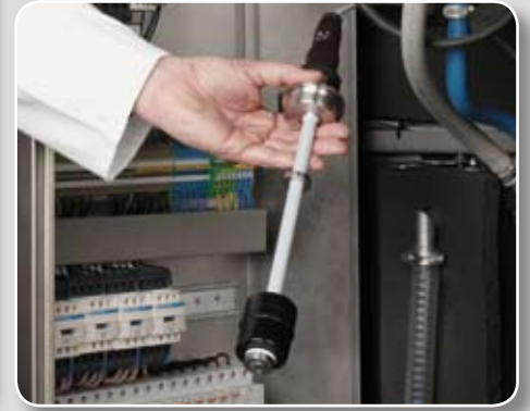
Der Wasserniveau-Schalter ist eines von zwei redundanten Sicherheitssystemen zur Regelung des Wasserstandes.
