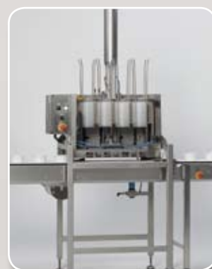
Zusätzlicher Deckelapplikator für praktische Wiederverschluss- Verpackungen
