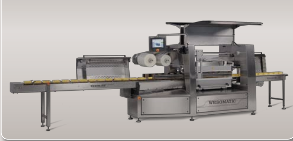
TL 1100 in Reinigungsstellung: Allseitig zu öffnen, verschieb- und wegklappbare Abdeckungen
