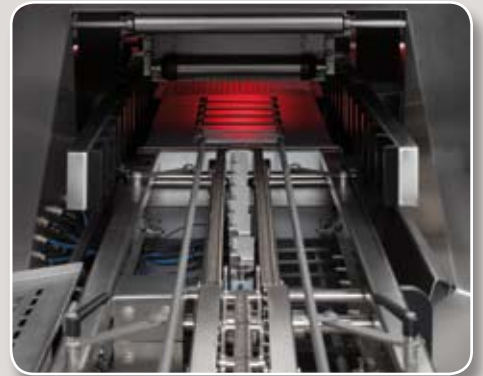
Präzise Schalenpositionierung durch Lichtleitertechnik
