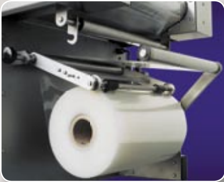
Serienmäßig integrierte Folienbremse für Unterfolienvorabspulung.
